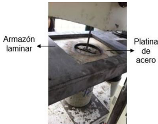
Figura 3. Soporte laminar y platina de acero para ensayo a tracción directa en anclaje estructural posinstalado
