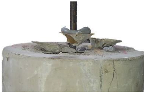
Figura 6. Falla por arrancamiento en anclaje estructural posinstalado
