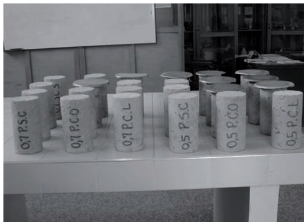
Figura 9. Probetas antes del ensayo de resistencia a la compresión
