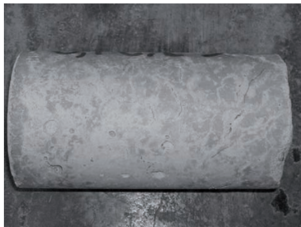
Figura 11. Fisuras a lo largo del perímetro lateral.
