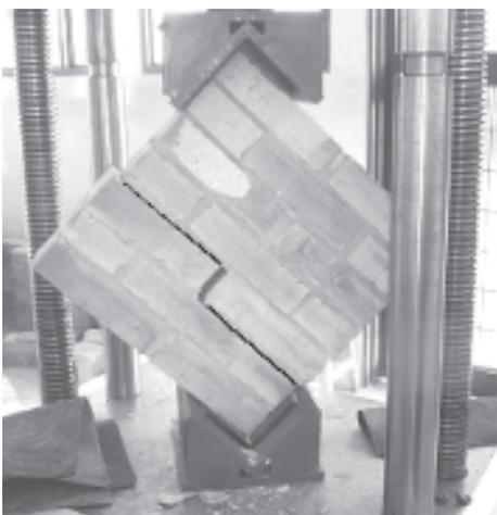
**Figura 14.** Descascaramiento de piezas durante el ensayo
