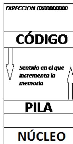
Figura 1. Espacio virtual de direcciones de los procesos, en sistemas GNU/Linux
