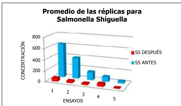
Figura 8. Remoción de Salmonella-Shigella en los filtros empacados en zeolita Fuente: elaboración propia
