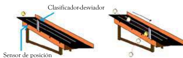
Figura 4. Clasificador electromecánico de mangos.
