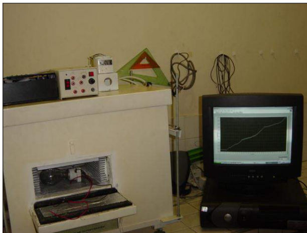
Figura 2. Calorímetro para circuitos electrónicos
