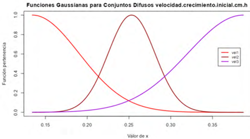
Figura 4. Funciones de pertenencia gaussianas para los conjuntos difusos de la velocidad de crecimiento inicial (cm/h).
